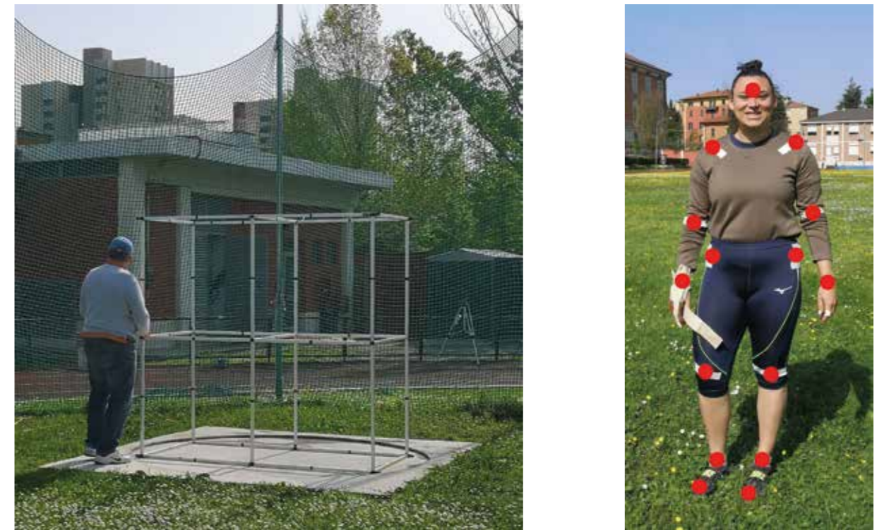
FIGURA 7 - Setup del metodo DLT. A sinistra la gabbia di calibrazione e a destra l'atleta Sara Fantini con i markers posizionati.
